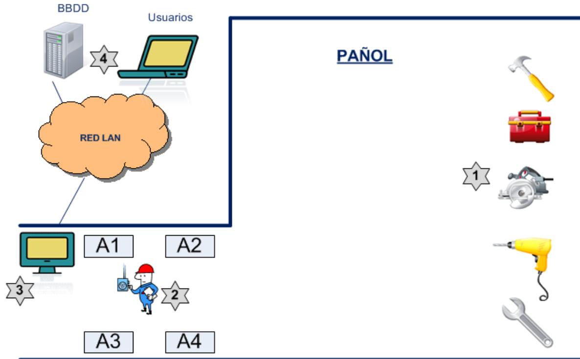
1. Las herramientas tienen instalado un tag RFID pasivo.
